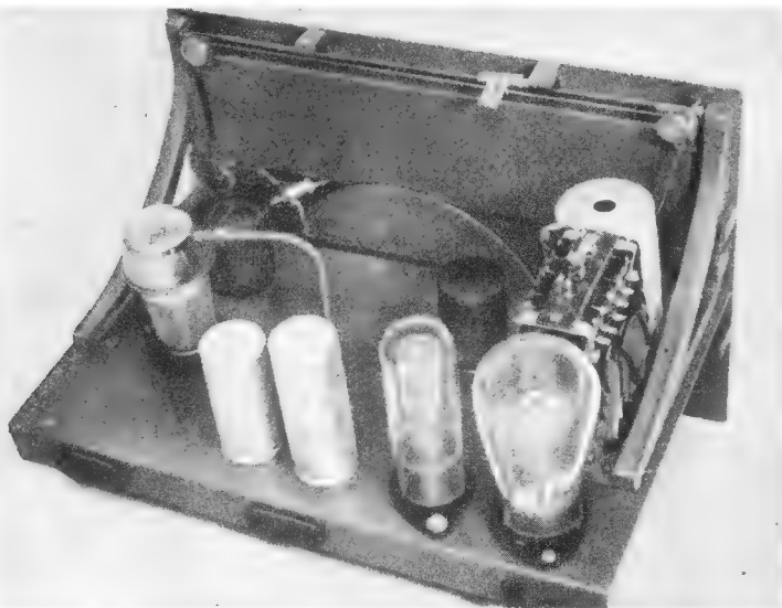
Bild 4. Rückansicht mit Oszillatorteil und Netzteil (rechts)
